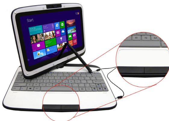
Сенсорный планшет – это чувствительная сенсорная панель с полосой прокрутки и двумя кнопками. Он может быть использован как компьютерная «мышь». Вы можете передвигать курсор по экрану, и с его помощью выбирать и запускать меню.
